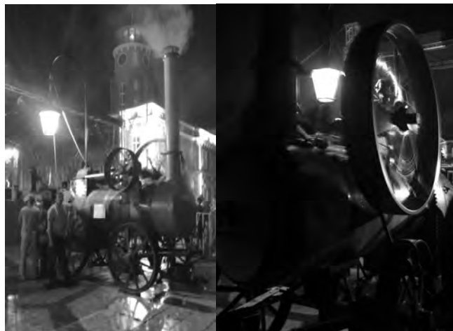
Rys. 4. Dymiąca lokomobila i paląca się w strugach deszczu lampa łukowa na placu im. Wł. Biegańskiego w Częstochowie (w tle budynek dawnego ratusza obecnie Muzeum Częstochowskie); kręcące się koło zamachowe lokomobili napędzające dynamomaszynę, zasilającą energią elektryczną lampę łukową
