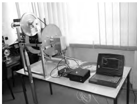
Rys. 8. Systemu pomiarowy do badania emisji elektromagnetycznej z osuwisk: 1 – bęben karotażowy z przewodem światłowodowym; 2 – sonda podziemna; 3 – blok przetwarzania; 4 – odbiornik naziemny; 5 – komputer PC
