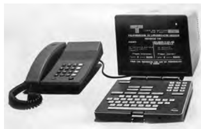
Rys. 4. Widok stanowiska systemu Minitel u abonenta sieci telefonicznej
