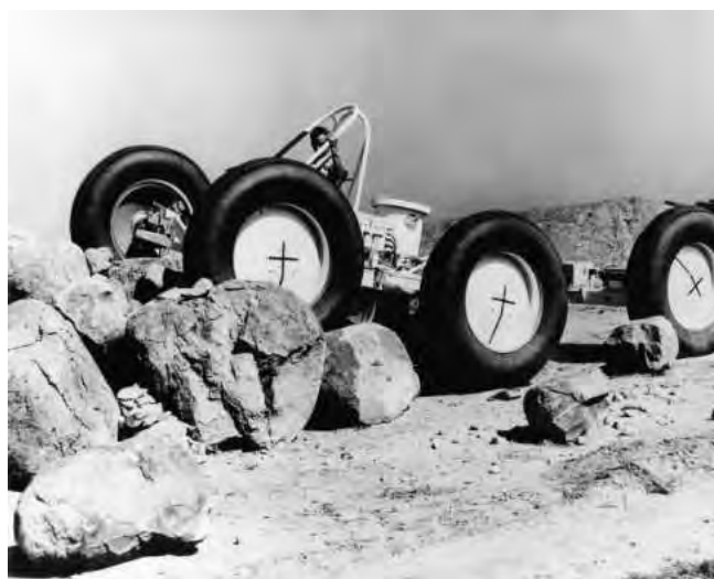
Rys. 3. Pojazd skonstruowany dla programu MTA przez GMDRL w trakcie pokonywania przeszkód terenowych [1]
