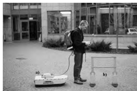
Rys. 6. Radar GPR z anteną; a) osłoniętą; b) nieosłoniętą
